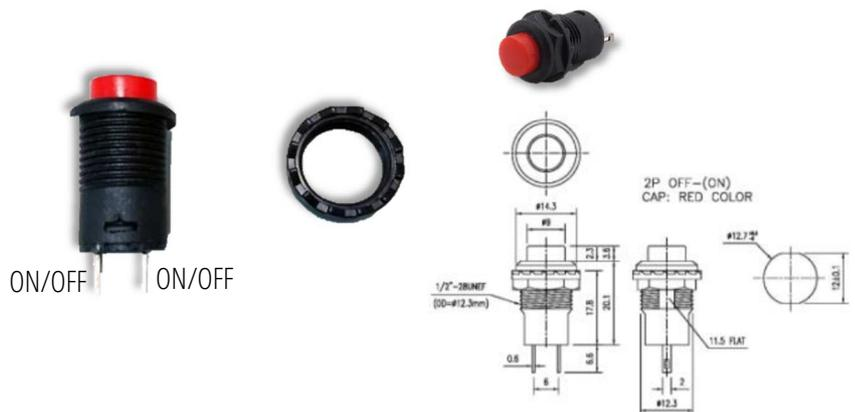
Technische Spezifikationen/ tech specs: Max. Spannung/voltage 125V DC; Max. Stromstärke/current: 3A
