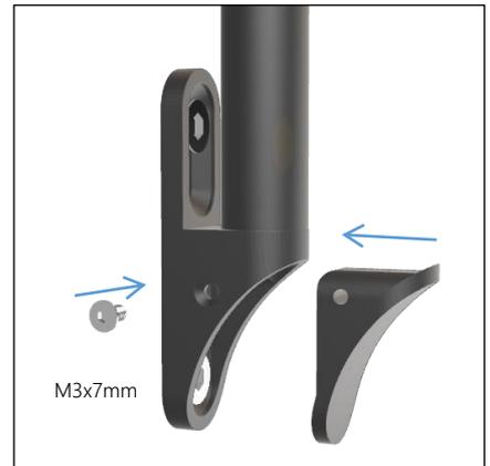
Durch die beim Betrieb auftkommenden Belastungen können sich Schraubverbindungen mit der Zeit lösen! Daher ist es notwendig, dass Sie vor jeder Fahrt den festen Sitz aller Teile überprüfen!
