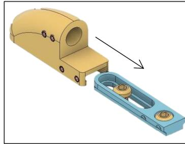
3) Schrauben Sie den passenden Stahlbolzen in den Spiegelarm (M6 oder M8) ACHTUNG: Bitte verwenden Sie Schraubensicherungslack!
