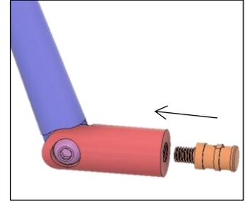
4) Schieben Sie den im Spiegelarm montierten Stahlbolzen in den am Motorrad montierten Adapter. Stellen Sie den Spiegel so ein, dass Sie uneingeschränkte Sicht nach hinten haben. ACHTUNG: Bitte verwenden Sie Schraubensicherungslack für die beiden oberen M3 Madenschrauben!
