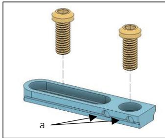
2) Schieben Sie den Adapter über die montierte Schiene und ziehen Sie die beiden unteren M3 Madenschrauben fest. ACHTUNG: Bitte verwenden Sie Schraubensicherungslack!
